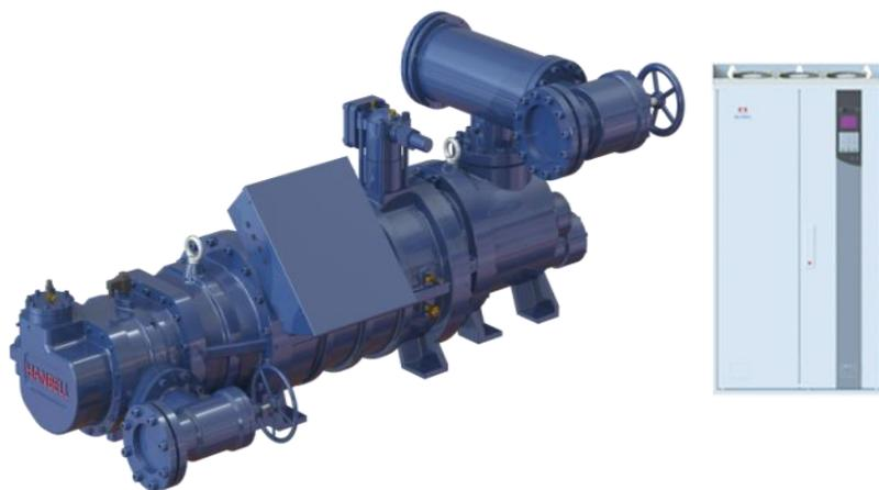
第三款产品是 RGII 系列新一代开启单级冷冻冷藏螺杆压缩机，采用全新齿形与结构设计，使性能大幅提升，全新轴封结构设计，使寿命大幅提升；产品自带中托架结构设计，无需对心，安装简易，维修方便；采用分级能调结构，满足机组卸载运行需求；自带经济器截止阀和内置排气止回阀设计，简化系统氟路管路配置；小机型可搭配常规三相异步电动机或永磁盘式电机，若搭配永磁盘式电机，电机效率约 96%~98%，相比于配置常规三相异步电动机长度减少约 50%，整体重量减少约 50%，可实现更高的能效与更紧凑的结构，适合并联机组应用。此产品汉钟精机还提供了各种配置方案，也提供多种销售方案，第一种是只销售单台压缩机，第二种是压缩机带着联轴器以及标准的电机一起销售，第三种是压缩机匹配盘式永磁的变频电机共同销售，可以使产品满足不同客户需求，在使用中发挥更好的效率。
